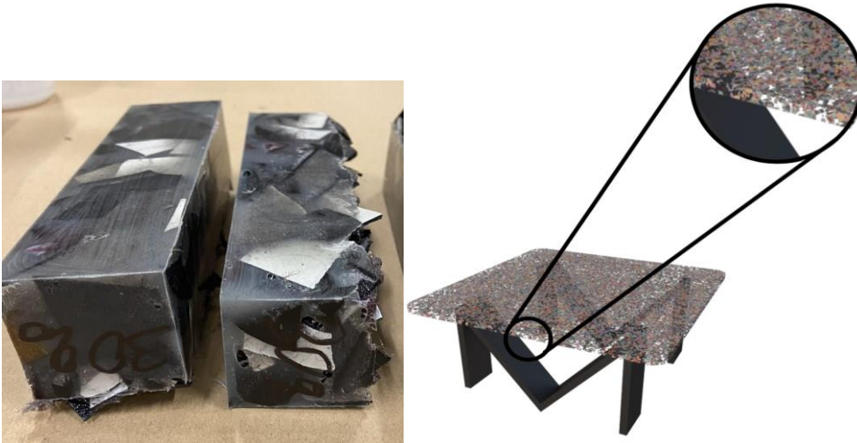
Figura 6. a) Material compuesto a partir de residuo textil y b) Propuesta de diseño de producto.
